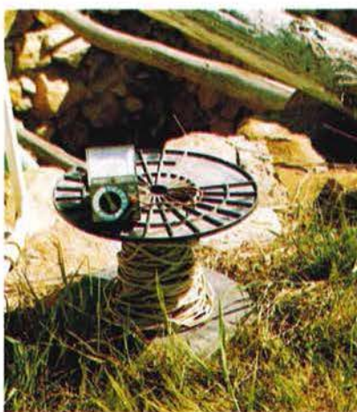
Sonda, compuesta por cable eléctrico doble y un amperímetro.
