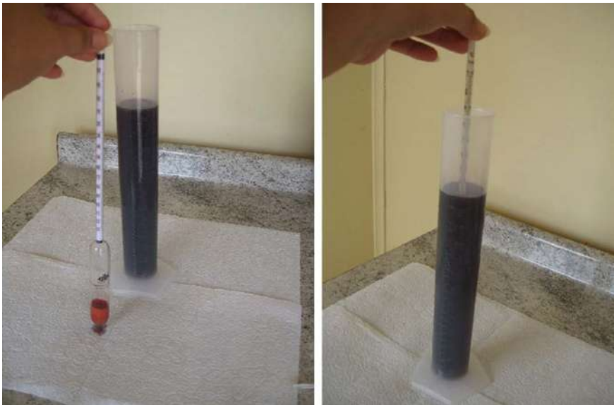
Foto 6.9. Evaluación de densidad del mosto utilizando un densímetro o mostímetro.
