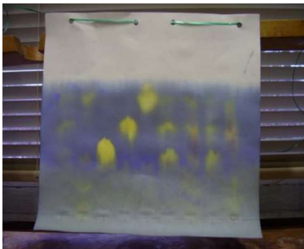
Foto 6.11. Evaluación de la fermentación maloláctica, mediante cromatografía de papel.
