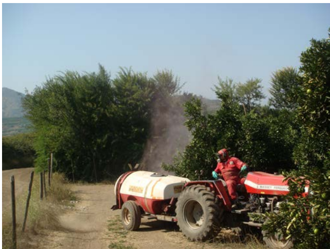
Figura 2. Tractor y pulverizador hidroneumático utilizado para el primer tratamiento de control para chanchito blanco de los cítricos (Fotografía propia).
