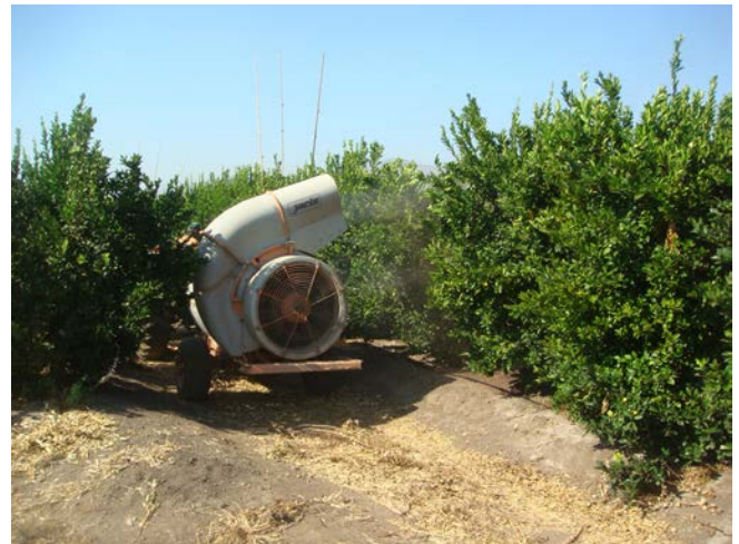
Figura 1. Tratamiento convencional agricultor (T1) con pulverizador hidroneumático con deflector de aire unilateral (Fotografía: Eliana San Martín).
