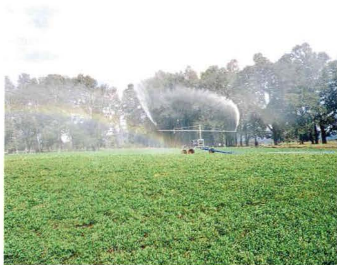
Foto 3. El carro de riego Vaguham es de origen australiano y constituye una variación diseñada especialmente para el riego de praderas.
