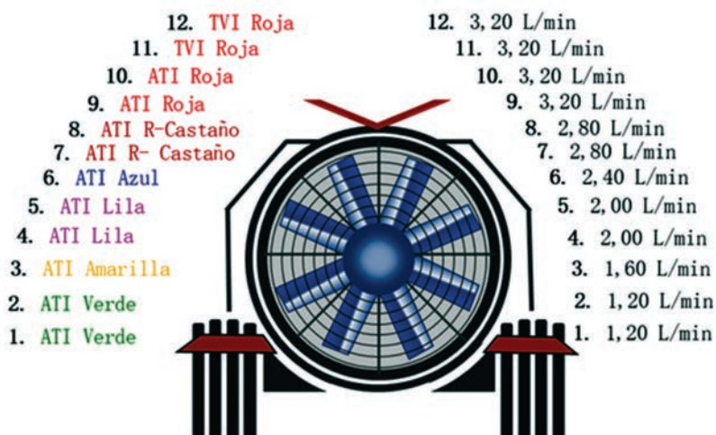
Figura 6.6. Esquema de la distribución apropiada en el pulverizador de acuerdo al ejemplo planteado en esta sección.
