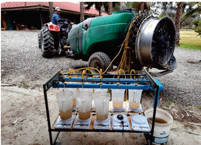
Figura 6.7. Medición práctica del caudal individual de boquillas en un pulverizador hidroneumático.
