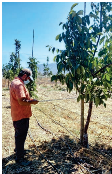
Figura 5. Mediciones de interceptación foliar PAR con equipo ceptómetro, huerto de nogal en Talhuén Ovalle.
