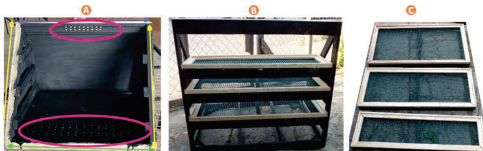
Figura 3. Modelo deshidratador solar. A) Frontal, B) Posterior, C) Bandejas. El interior debe pintarse de color negro.
