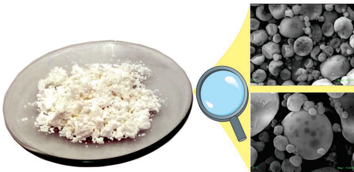
Figura 2. Fotografía obtenida por Microscopía Electrónica de Barrido (SEM) de la morfología externa de las micropartículas con aceites esenciales obtenidas por secado por atomización.
