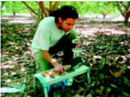
Foto 15. Cámara de presión
