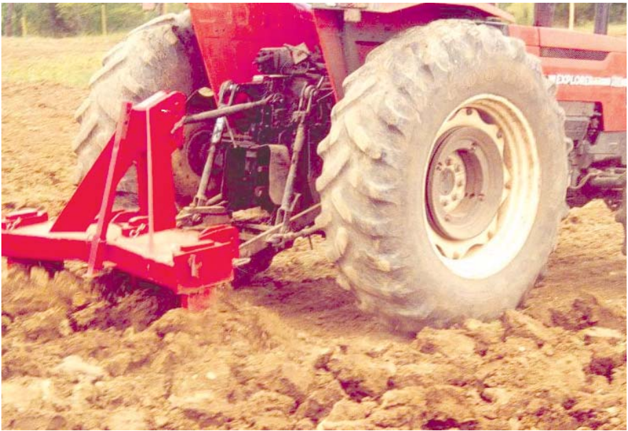
FOTO 1: Suelo arcilloso con consistencia de cementado, sólo para labores de subsolado de suelo.
