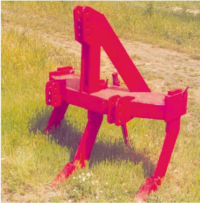
FOTO 8: Arado subsolador de enganche integral de tres brazos.
