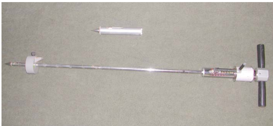
FOTO 7: Medidores de compactación de suelo. Arriba: durómetro de suelo YAMANAKA. Abajo: registrador de penetración DAIKI.
