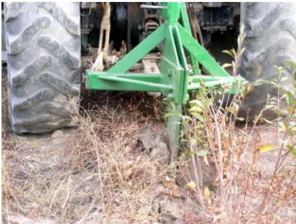
Foto 7. Tractor y arado subsolador de un brazo, en una labor de rotura del suelo para replante de frutales.
