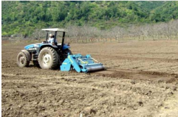
Foto 9. Arado rotativo en labor de preparación de suelos para la incorporación de un fumigante, previo al replante de un frutal.
