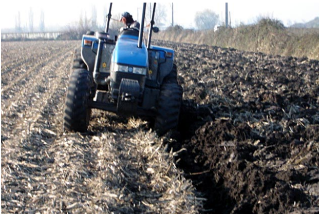
Foto 1. Ruedas del tractor, en una labor de aradura con vertedera, ubicadas en el surco de aradura compactando el suelo.
