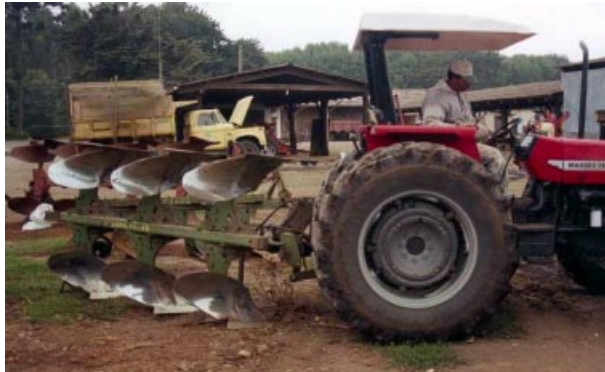
Foto 3. Arado de vertedoras reversible, implemento de uso masivo en el mundo.
