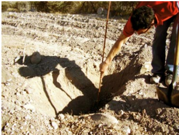
Foto 8. Forma práctica para evaluar en terreno la profundidad de trabajo del subsolador, utilizando una varilla graduada.
