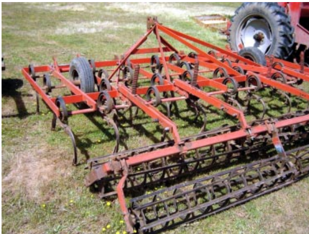
Foto 11. Rastra vibrocultivador, equipo constituido por un “chasis” que soporta brazos flexibles en forma de “S”, ideales para el control de malezas perennes.
