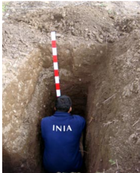
Foto 1. La observación del perfil de suelo en una calicata, permite establecer la presencia de algún impedimento físico y definir el tipo de labores de manejo del suelo.
