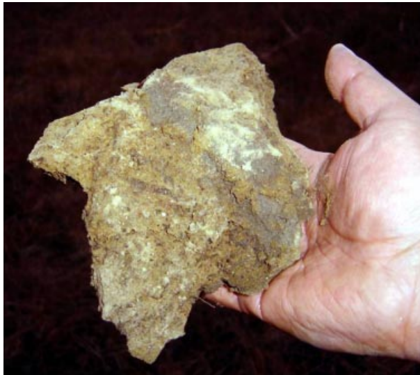
Foto 2. Forma característica de un terrón muestreado en un horizonte compactado. Obsérvese la amplitud del eje horizontal, con relación al eje vertical.
