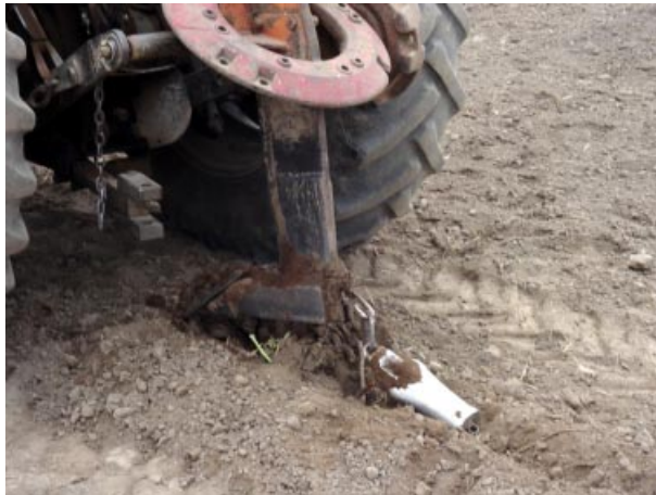
Foto 7. Arado subsolador y balín topo o torpedo, adecuado para construir túneles de drenaje.
