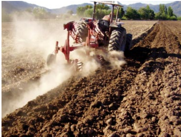
Foto 9. Arado de vertedera reversible en su labor de inversión de suelos.
