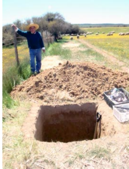
Foto 1. La observación del perfil de suelo en una calicata, permite establecer la presencia de algún impedimento físico y definir el tipo de labores de suelo. Hidango, Litueche.
