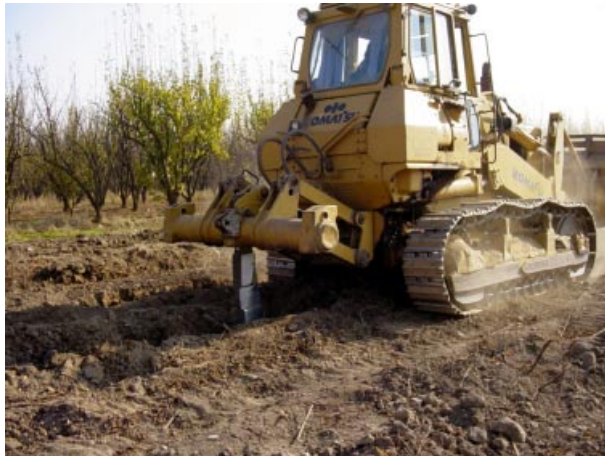
Foto 4. Tractor sobre orugas o “Bulldozer” con subsolador, apropiado para labores profundas en suelos secos o con bajo contenido de humedad. Fundo El Coigüe, Requínoa.
