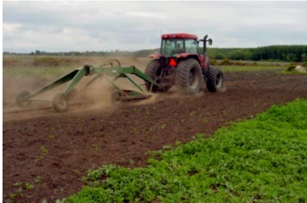
Foto 11. Movimiento superficial de suelo con una microniveladora, emparejándolo para el riego.
