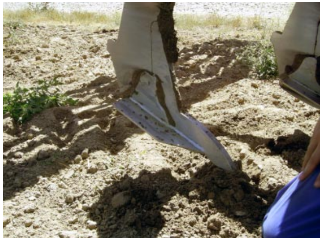
Foto 8. Bota o pie de un arado subsolador con punta o cincel intercambiable.
