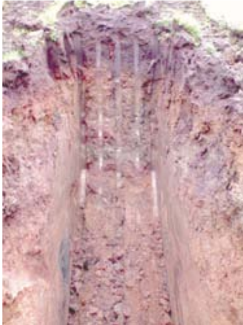
IMAGEN 15: Perfil de suelo sobre alterita intrusiva de morfología Plateau en altura
