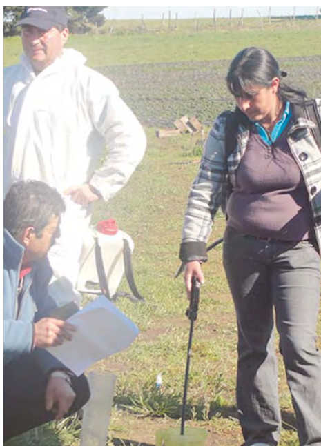
FOTOGRAFIA 70: MEDICIÓN DEL CAUDAL DE LA BOQUILLA.
