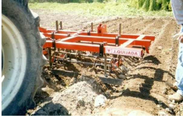
Figura 14. Botador de camas trabajando sobre camellón de invierno.
