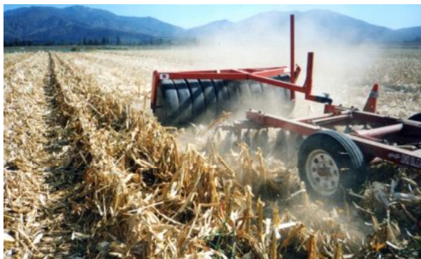
Figura 5. Rastra de discos más rodillo rastrojero de neumáticos.
