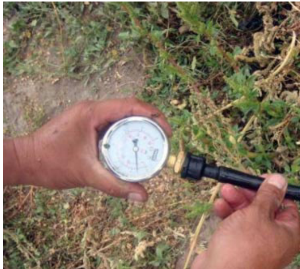
Foto 6. Medición de presión en la lateral por medio de un manómetro de glicerina.
