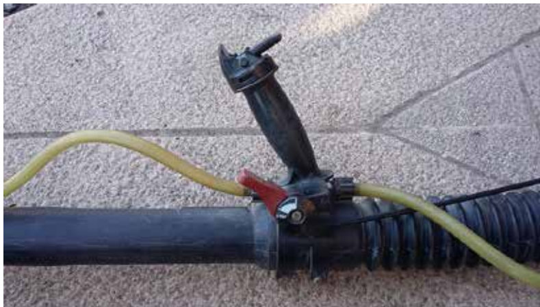
Figura 14.3. Manilla reguladora de aceleración del motor, utilizada para la variación de la velocidad del viento.
