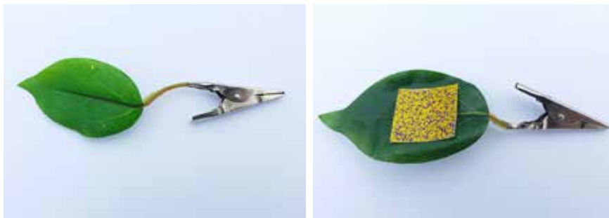
Figura 14.9. Uso de hojas plásticas para colocar papeles hidrosensibles al interior del follaje. Los “perros” utilizados se sujetan directamente en las cañas de las plantas.
