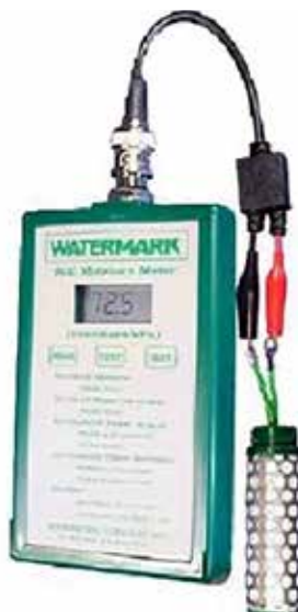
Figura 11.6. Equipo de medición en campo para el control del riego. Izquierda: tensiómetro. Derecha: watermark.
