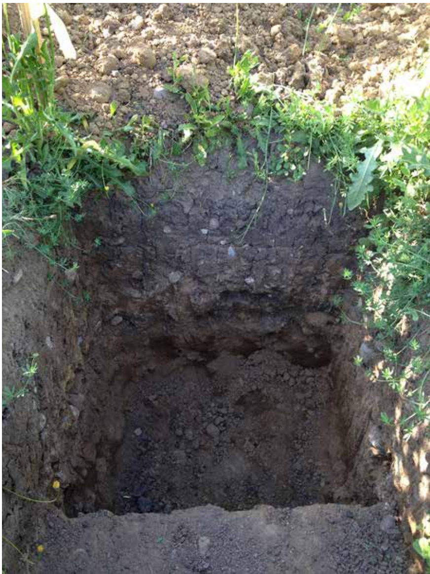
Figura 6.1. Calicata para visualizar el perfil de suelo, profundidad de raíces y humedad.
