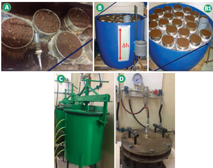
Figura 10: Procedimiento de la determinación de la Curva de Retención de Agua (pF): a) saturación por ascenso capilar, b) drenaje a distintas tensiones (a través del cambio de altura: \Delta h del espejo de agua) en bandejas de arena, b1) vista desde arriba, c) drenaje en olla de presión, d) drenaje en plato de presión.
