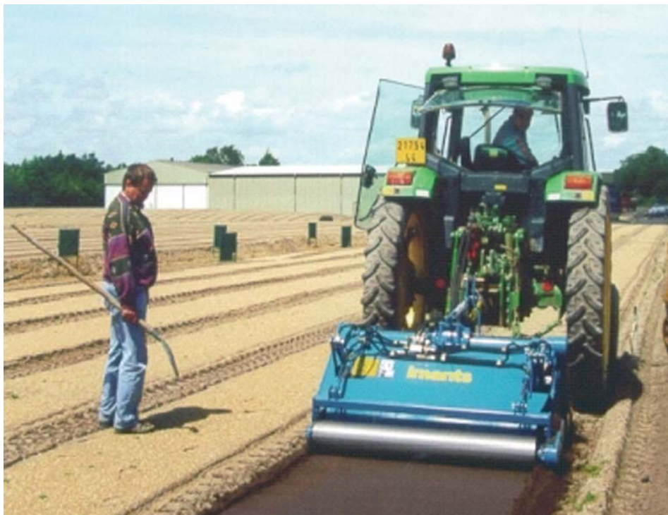
La máquina spading machine inyecta el producto al suelo, lo incorpora y mezcla y finalmente sella la superficie tratada con un rodillo liso.
