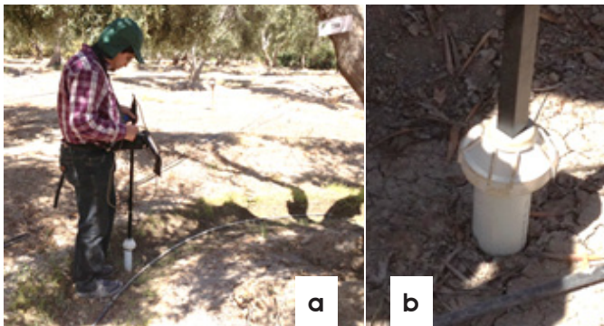
FIGURA 3. (a) Medición con FDR (Diviner 2000®) en proyecto. (b) Tubo de acceso PVC y sensor FDR.
