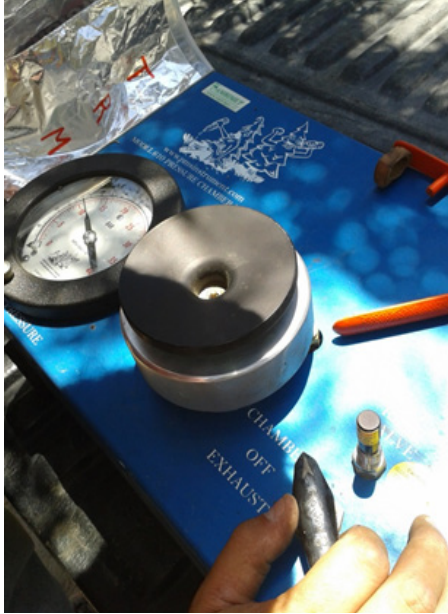
FIGURA 6. Aplicación de nitrógeno en medición de potencial hídrico en ramilla de olivo mediante una cámara de Scholander.
