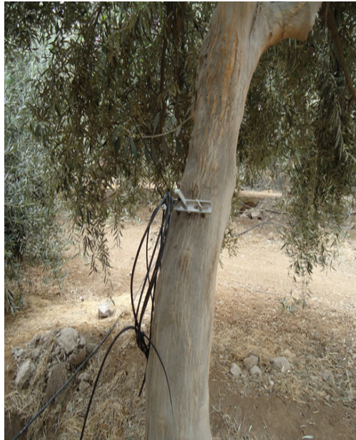
FIGURA 10. Sensor de dendrometría en olivo del Valle de Azapa.
