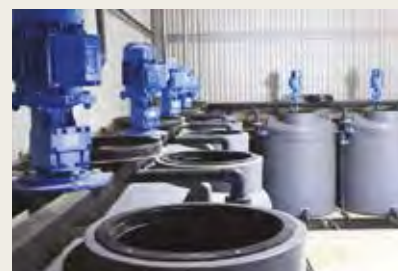
▲ Estanques de mezcla primaria de la central de riego, diseñada por Teknoriego para este proyecto.
