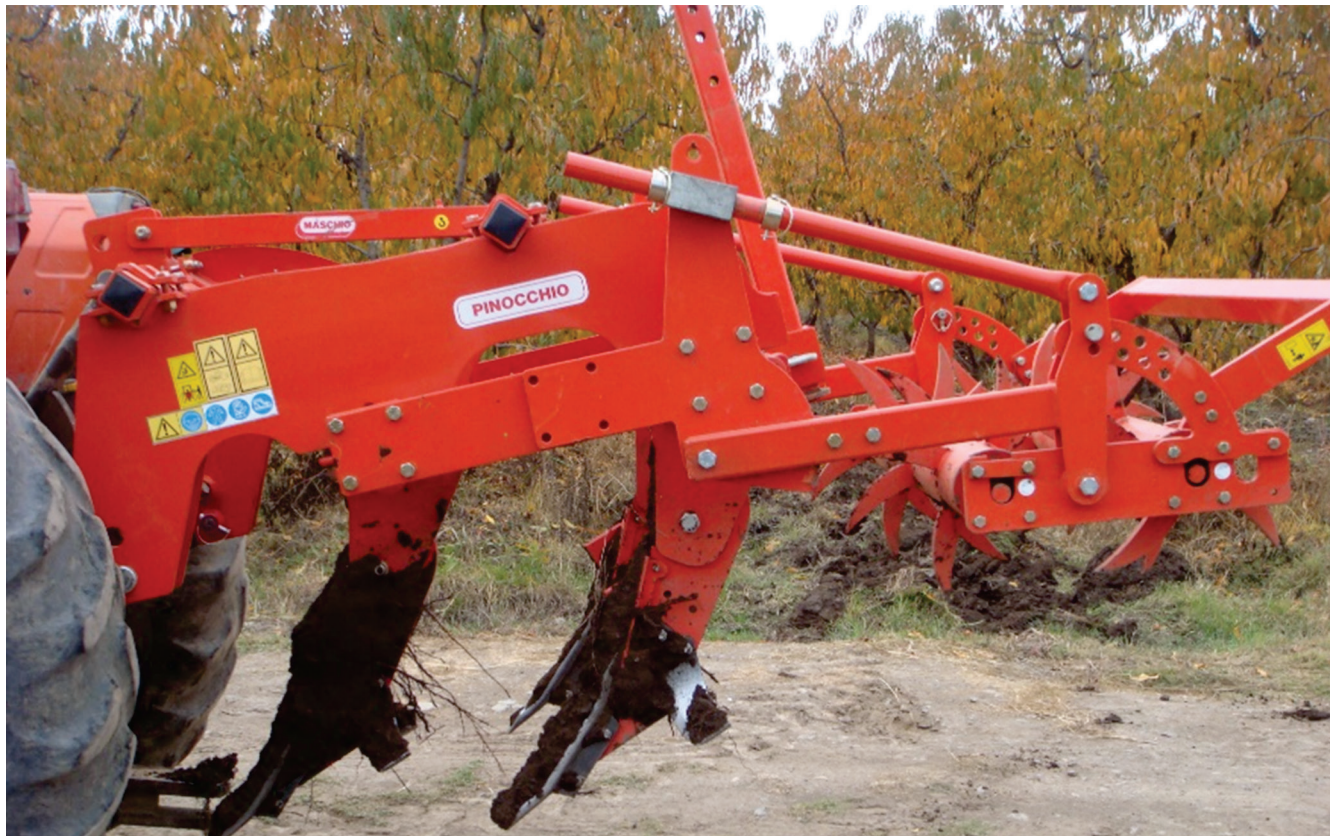
Figura 2. Arado subsolador de tres brazos, recomendado para una labor entre las hileras del frutal.
