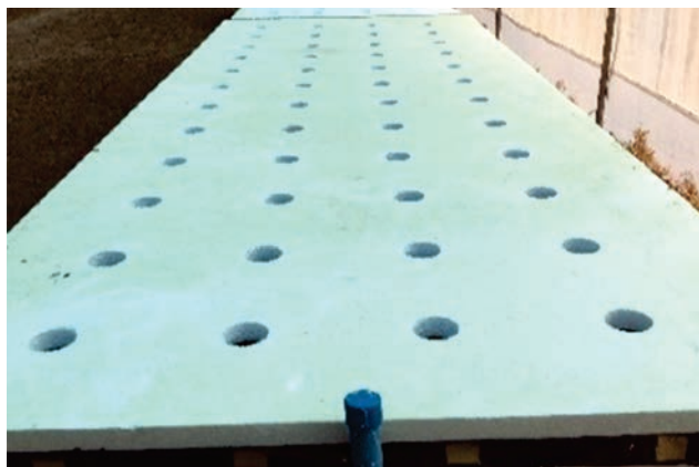
Figura 4. Cajón con tapa de lámina aislante con agujeros a 25x25 cm.
