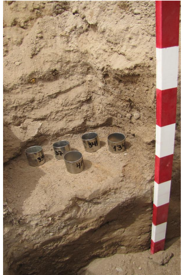
Fotografía 2. Toma de muestra de suelo en una calicata con cilindros metálicos.
