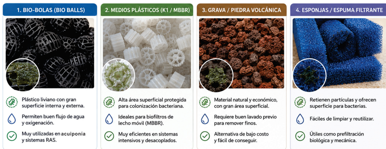
Figura 3. Alternativas de soporte para bacterias nitrificantes en sistema acuipónico.
