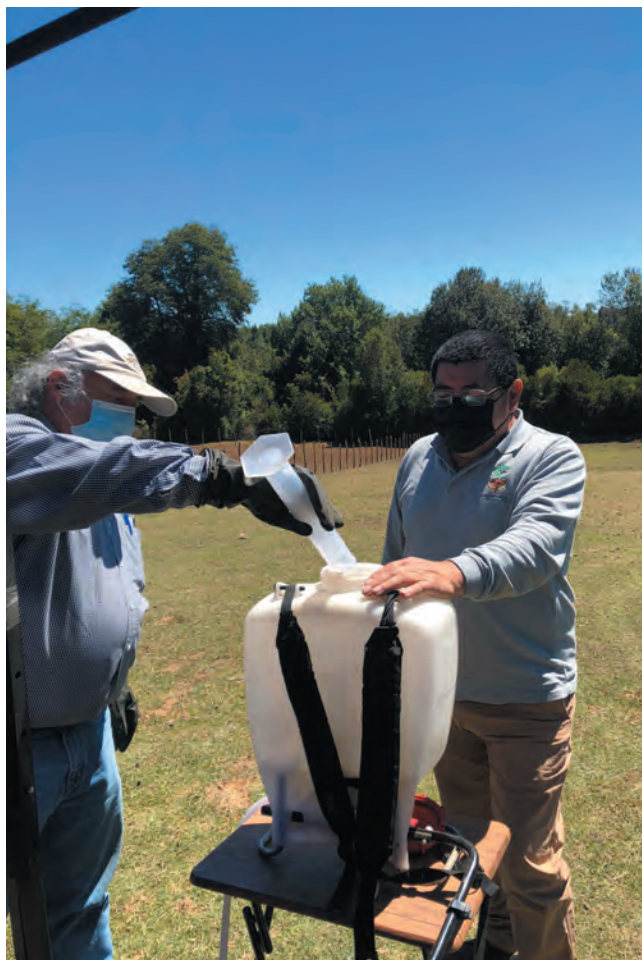
Figura 2. Llenado de equipo con agua limpia para calibración
