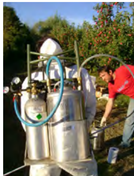
Foto 1. Bomba de espalda, empleada en las aplicaciones de Harvista™Technology
