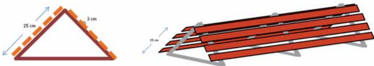
Figura 4. Ducto de ventilación
