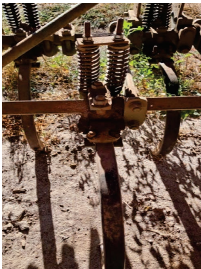
Figura 4. Sistema de doble resorte de la mordaza de unión que une el cincel al marco portador o chasis del arado.
