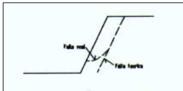
FIGURA 4. Mecanismo de falta de un talud.
