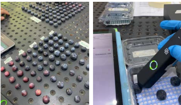
Figura 1. Medición con sensor NIR portátil capaz de detectar tempranamente la presencia de Botrytis spp. y Alternaria spp. en frutos de arándano.
