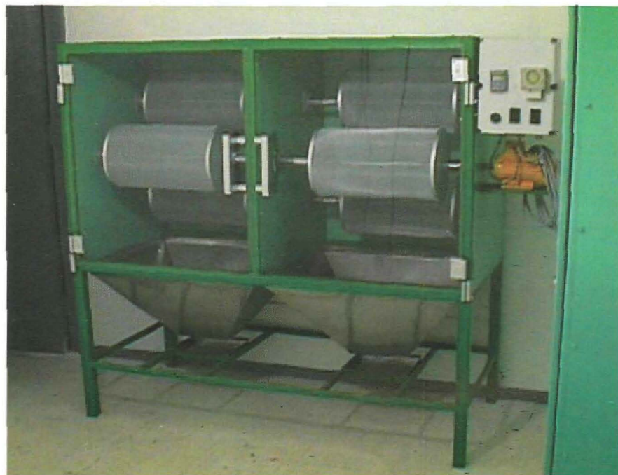
Foto 8. Máquina semiautomática cosechadora de huevos.
