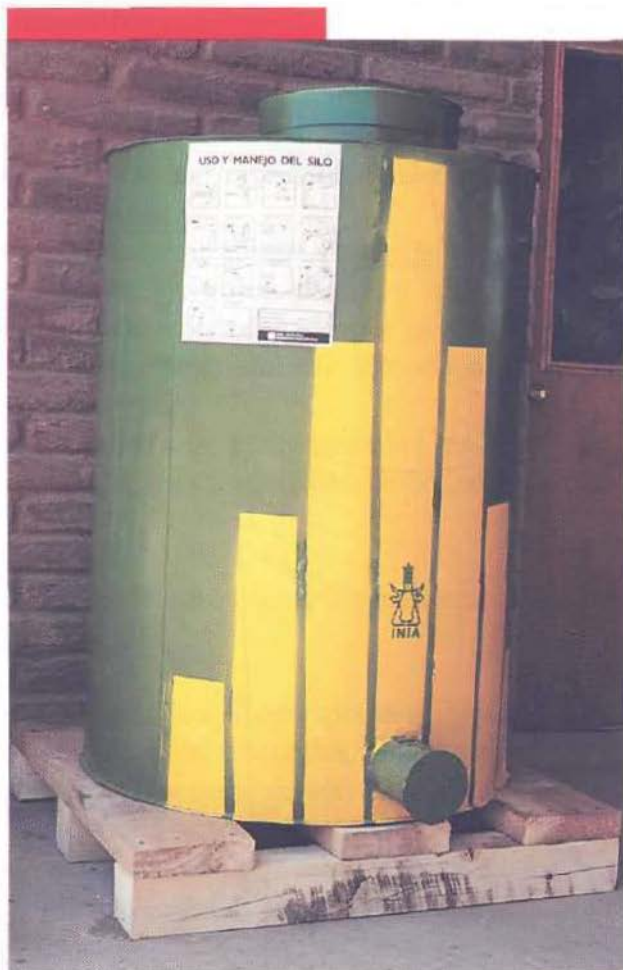
Foto 21. Silo pequeño construido en hojalatería, es adecuado para almacenar maíz a granel en bajos volúmenes.
