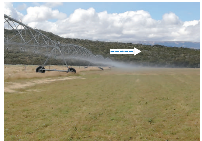
Figura 5: Efecto del viento en un riego por aspersión sistema de Pivote.
