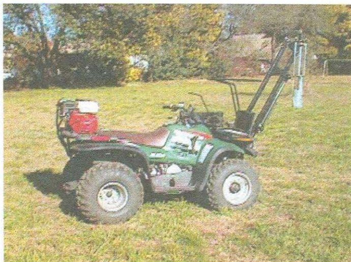
Foto 1.1. Vehículo todo terreno equipado con barreno hidráulico tipo espiral.
