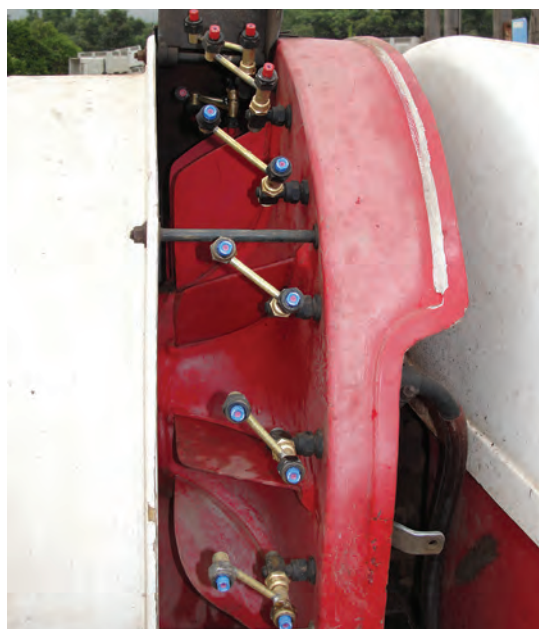
Foto 48. Surtidores dobles (multiplicadores de gotas) para aumentar cubrimiento de las aplicaciones.
