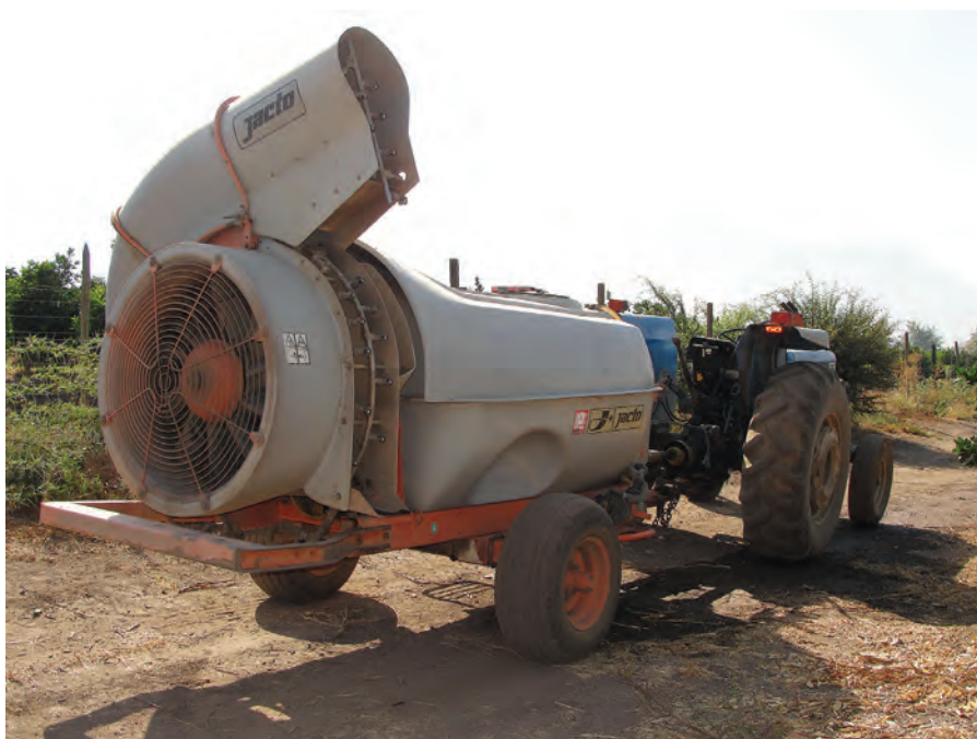
Foto 54. Tractor y pulverizador hidroneumático con deflector unilateral tratamiento convencional del agricultor.
