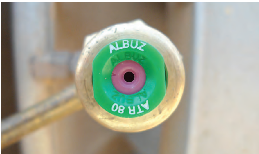
Foto 50. Boquillas de cono vacío (AlbuZ ATR) codificada por color (Albuz-spray).
