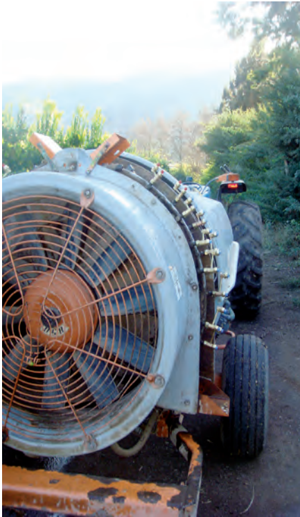
Foto 55. Tractor y pulverizador hidroneumático sin deflector unilateral Tratamiento INIA.
