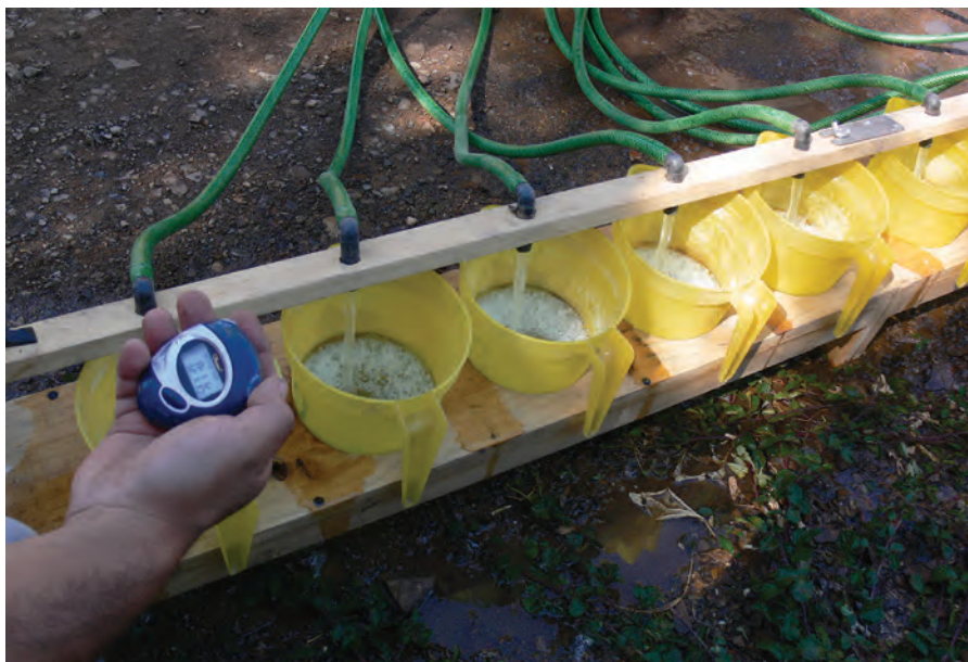
Foto 51. Medición práctica del caudal individual de las boquillas.
