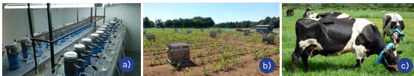
Figura 2. Ejemplos de métodos empleados para la cuantificación de las emisiones de GEI en suelos bajo praderas: a) cámara dinámica para uso bajo condiciones semi-controladas, b) cámara dinámica para cuantificación bajo condiciones de campo; y, por fermentación entérica a través de la c) técnica de hexafluoruro de azufre o SF_6 (fotografía gentileza de Dra. Camila Muñoz, INIA Remehue).
