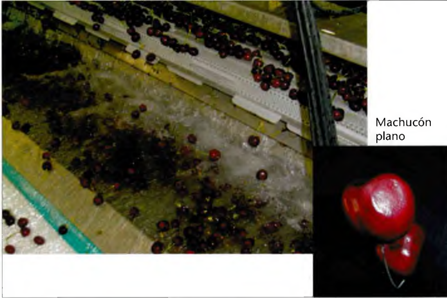
■ FIG. 7. MACHUCÓN PLANO EN CEREZAS AL IMPACTAR SOBRE SUPERFICIE DE ACERO.
