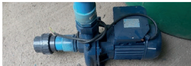
Figura 2. Electrobomba centrífuga monofásica utilizada para riego.
