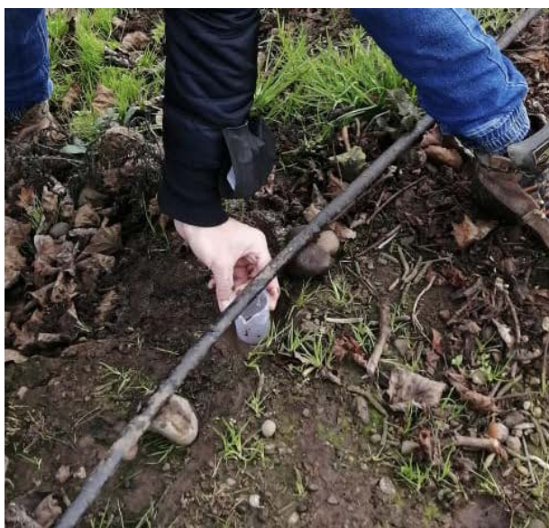
Figura 1. Monitoreo de la precisión de entrega de agua y fertilizantes en un riego tecnificado usando sistema por goteo.
