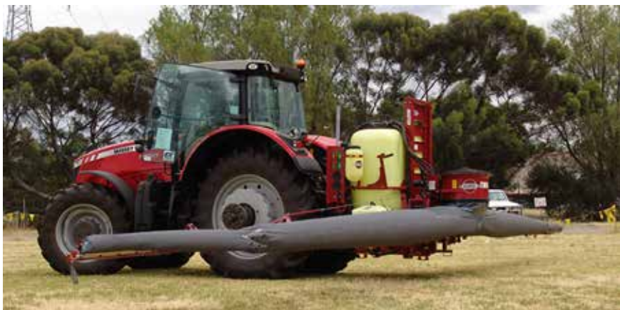
Figura 8.1. Pulverizador hidráulico de barra con asistencia de aire (Fuente: Agrimec, 2017).
