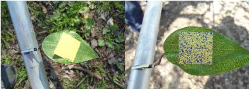
Figura 8.7. Papeles hidrosensibles. Izquierda, antes de la pulverización. Derecha, cubrimiento ideal obtenido posterior a la aplicación.
