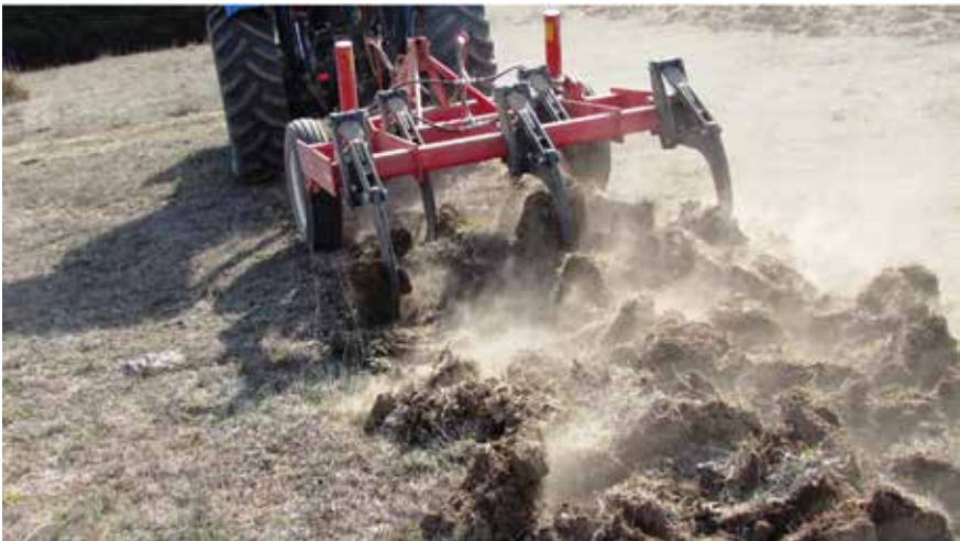
Figura 1.7. Arado subsolador-escarificador de 5 puntas, equipo adecuado para romper problemas de pie de arado en un terreno.
