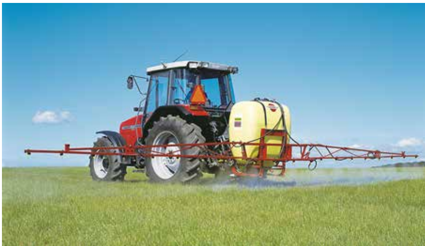
Figura 8.2. Pulverizador hidráulico de barra para cultivos bajos (Fuente: Hardi, 2016).
