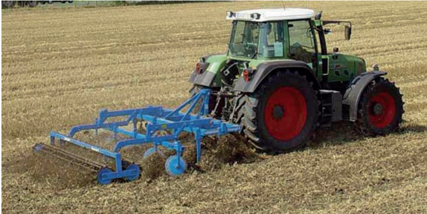
Foto 4.8. Trabajo del cultivador Lemken Smaragd 9 sobre el rastrojo de cereal de grano pequeño. Fuente: Lemken, 2010.
