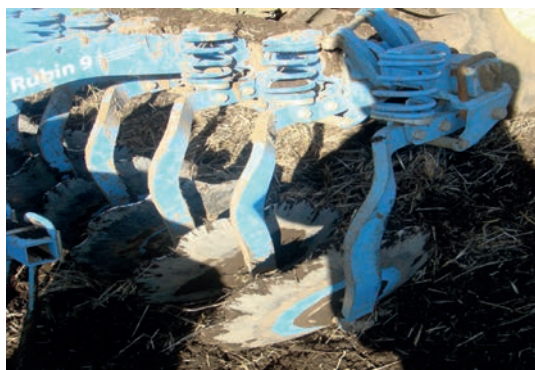
Foto 4.7. Mayor detalle del sistema de suspensión individual de cada disco. (Foto Jorge Riquelme).
