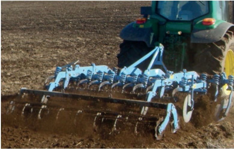
Foto 4.5. Rodillos posteriores de la rastra Rubin, mullen y controlan la profundidad de trabajo. (Foto Jorge Riquelme).
