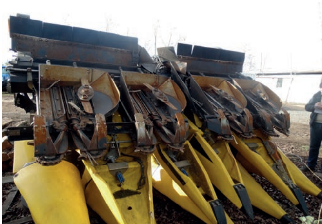
Foto 4.1. Vista invertida de la plataforma de corte maicera con sistema de picado de tallos marca Geringhoff. (Foto Carlos Ruiz).
