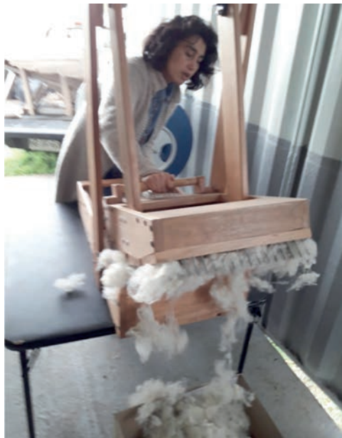
Figura 31. Abridora de lanas adquirida con el proyecto PYT-2016-0274.
