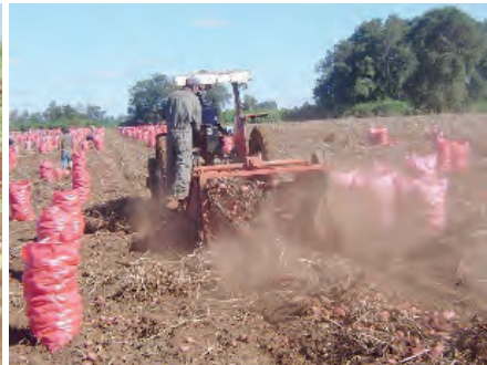
Figura 9.7. Arrancadora de dos hileras, destapando papas. Teodoro Schmidt, Región de La Araucanía.
