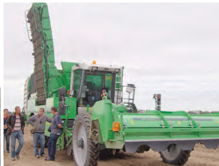
Figura 9.12. Automotriz de cuatro hileras con bunker acumulador de 8 t. Holanda.
