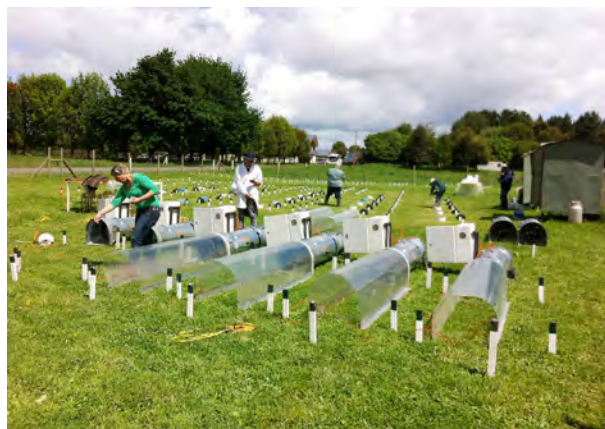
📍 Figura 1. Evaluaciones de campo para la emisión de gases con efecto invernadero y volatilización de amoníaco.
