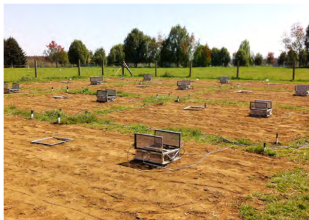
📍 Figura 2. Equipo de medición automatizado para evaluar la emisión de óxido nitroso y metano desde suelos.
