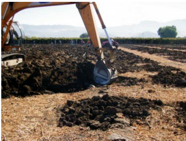
Foto 6. Labor de arranque de la base del tronco y raíces de la planta frutal con una retroexcavadora.
