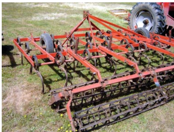
Foto 11. Rastra vibrocultivador, equipo constituido por un “chasis” que soporta brazos flexibles en forma de “S”, ideales para el control de malezas perennes.
