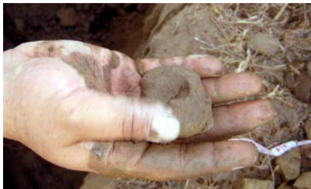
Foto 4. Forma práctica de determinar en forma aproximada la textura de un suelo en terreno, desagregando una muestra de suelo húmedo en la palma de la mano.
