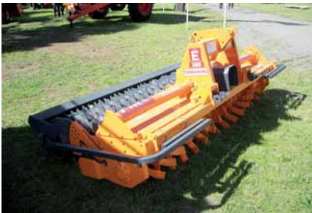
Retrofresadora de rotor horizontal y cuchillas
