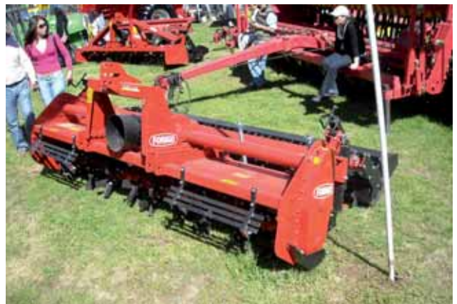
Retrofresadora de rotor horizontal y cuchillas
